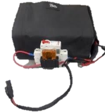
Figura 18 – Bateria LiFePO 4 , 36V 10Ah.
