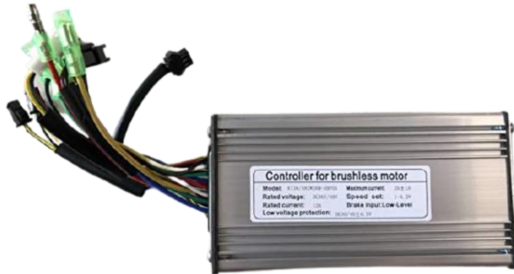
Figura 15 - Módulo de Controle modelo KT36/48ZWSRM-NBPO3.
