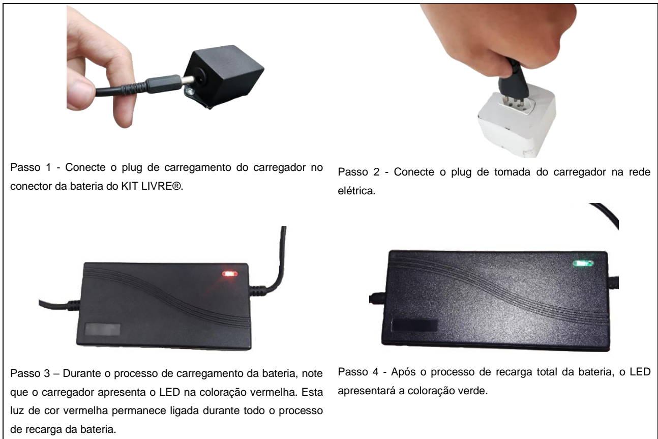
Figura 24 – Processo de recarga da bateria do KIT LIVRE®.
