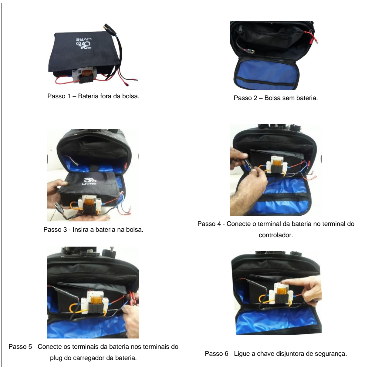
Figura 22 - Sequência para acoplamento da bateria.
